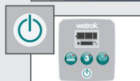
Överbelastningsskydd: Om borstmotorn blockeras under pågående arbete, sker automatiskt stopp! Genom att maskinen åter slås irfån / till går det att fortsätta med arbetet.
